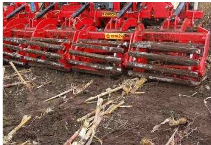
■ Die Gliederstabwalze von Knoche/Brix („Zünlerschreck“) hinterlässt aufgefaserte Stoppeln mit weichen Knoten und bringt die Stoppeln in Bodenkontakt.
