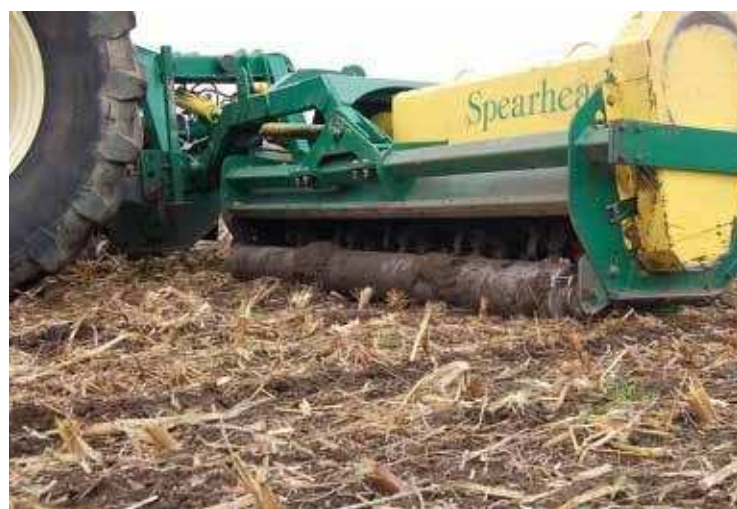
■ Der Schlegelmulcher im Frontanbau sollte möglichst tief eingestellt werden, um auch das unterste Internodium zu erfassen. Die Qualität der Stoppelbearbeitung ist hervorragend. (Fotos: Buchholtz)
