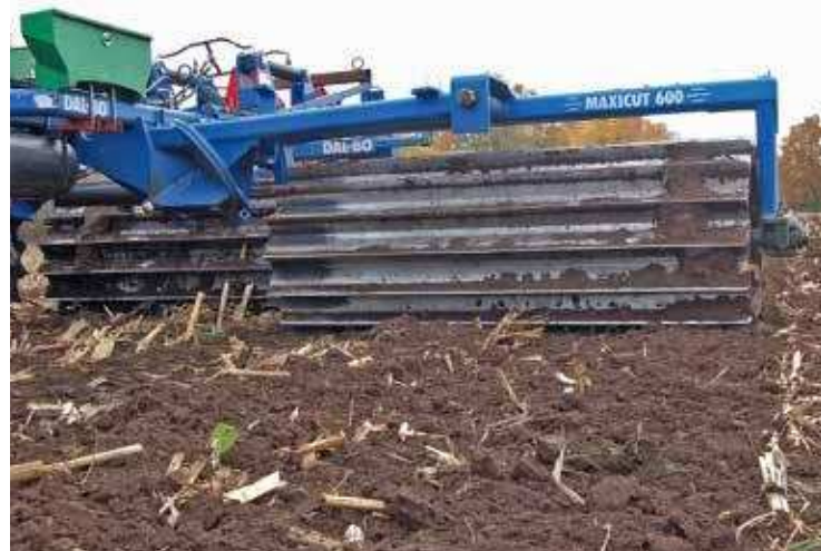
■ Die Schneidwalze von Dalbo quetscht und zerschneidet die Stoppeln. Auf schweren Böden und unebener Bodenoberfläche ist das Arbeitsergebnis nicht befriedigend.
