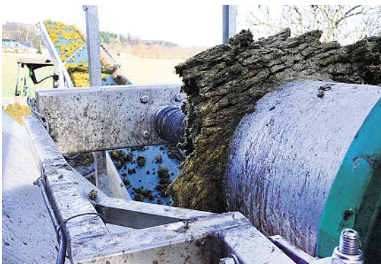
Die stapelfähigen Feststoffe wirken wie ein Schwamm. Der Lagerraumbedarf im Dünngüllebehälter sinkt um bis zu 20 %.
