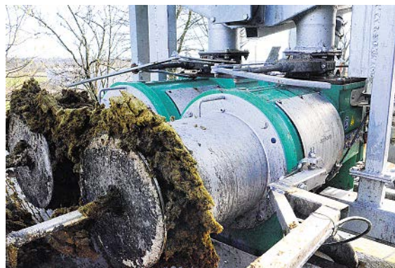
Austritt der Feststoffe an den Stirnseiten zweier Pressschnecken-Separatoren. Mit den pneumatischen Gegendruck-Stempeln kann der gewünschte Trockenmassegehalt der Feststoffe eingestellt werden.
