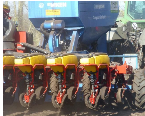
Abb.4: Zusätzliche Tanks für die Saatbanddüngung mit Mikrogranulat, in Fahrtrichtung hinter den Saatgutbehältern montiert.
