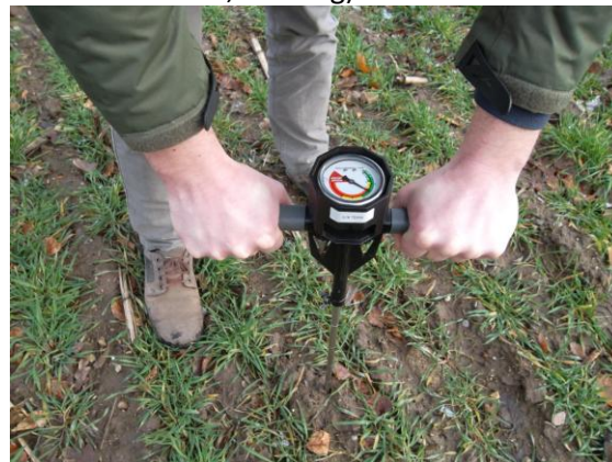
Bodenpenetrometer zur Messung der Bodendichte
