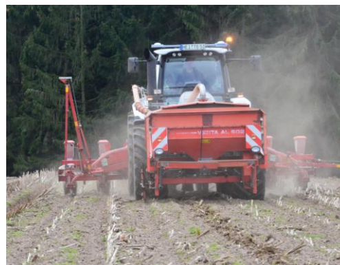
Maisaussaat GPS-gestützt direkt oberhalb des Güllebandes 9 Tage nach der Injektion der Gülle (19.04.2012)
