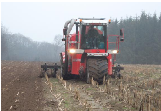
Selbstfahrer beim Anlegen eines Gülle-Unterfußbandes mit Strip-Till Bodenbearbeitung (10.04.2012)
