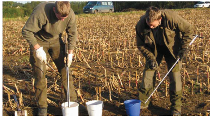
Nmin-Probenahme bis 90 cm Tiefe mit Pürkhauer (links) und Göttinger Bohrstock
