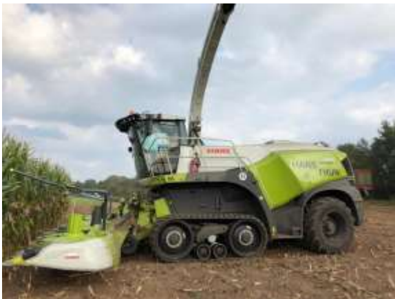
Abb. 1: Beerntung des Versuchs am 23. September mit einem modernen Feldhäcksler mit Ertragserfassung und NIRS-Sensor für die TS-Bestimmung.
