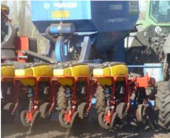
Abb.4: Zusätzliche Tanks für die Saatbanddüngung mit Mikrogranulat, in Fahrtrichtung hinter den Saatgutbehältern montiert.
