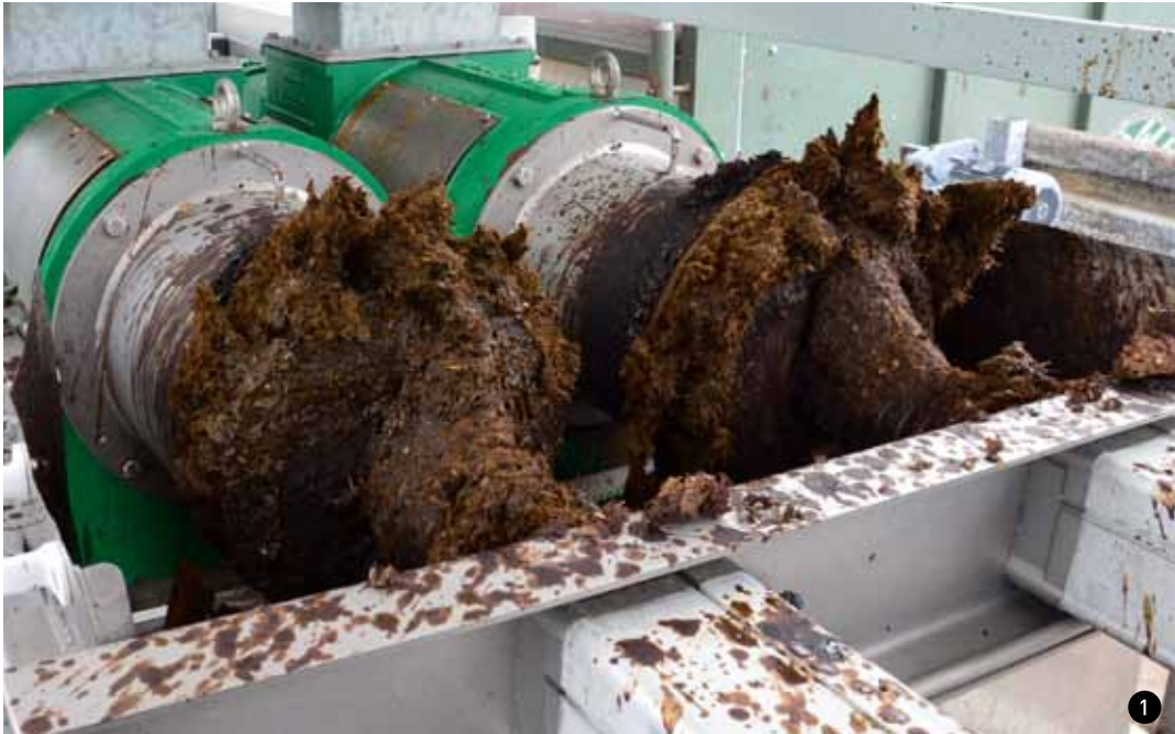
1 Pneumatische Gegendruck-Stempel verhindern wirksam einen Gölledurchbruch.
