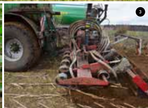
1 Direkteinarbeitung per Scheibenegge mit einer Arbeitsbreite von sechs Metern nach dem ersten Grasschnitt zur Maisbestellung Mitte Mai. 2 Raps-Rückstände im Winterweizen nach pflugloser Bestellung wirken wie kleine Erosionsbarrieren. 3 Direkteinarbeitung von Wirtschaftsdüngern mit dem „Güllegrubber“ verhindert Direkteinträge und Abschwemmung von der Bodenoberfläche in angrenzende Gewässer.
