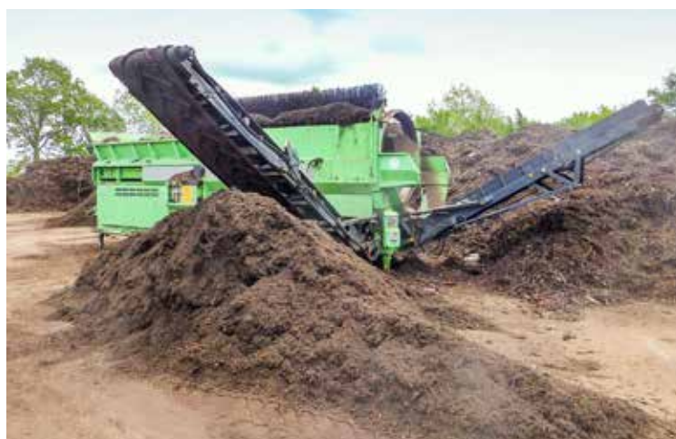
Vor der Vermarktung werden Grobbestandteile, Fremdstoffe und Steine mit einer Trommelsiebanlage entfernt. Feinkörnige Komposte sind in der Regel ärmer an Fremdbestandteilen. Fotos (4): GWS Nord
