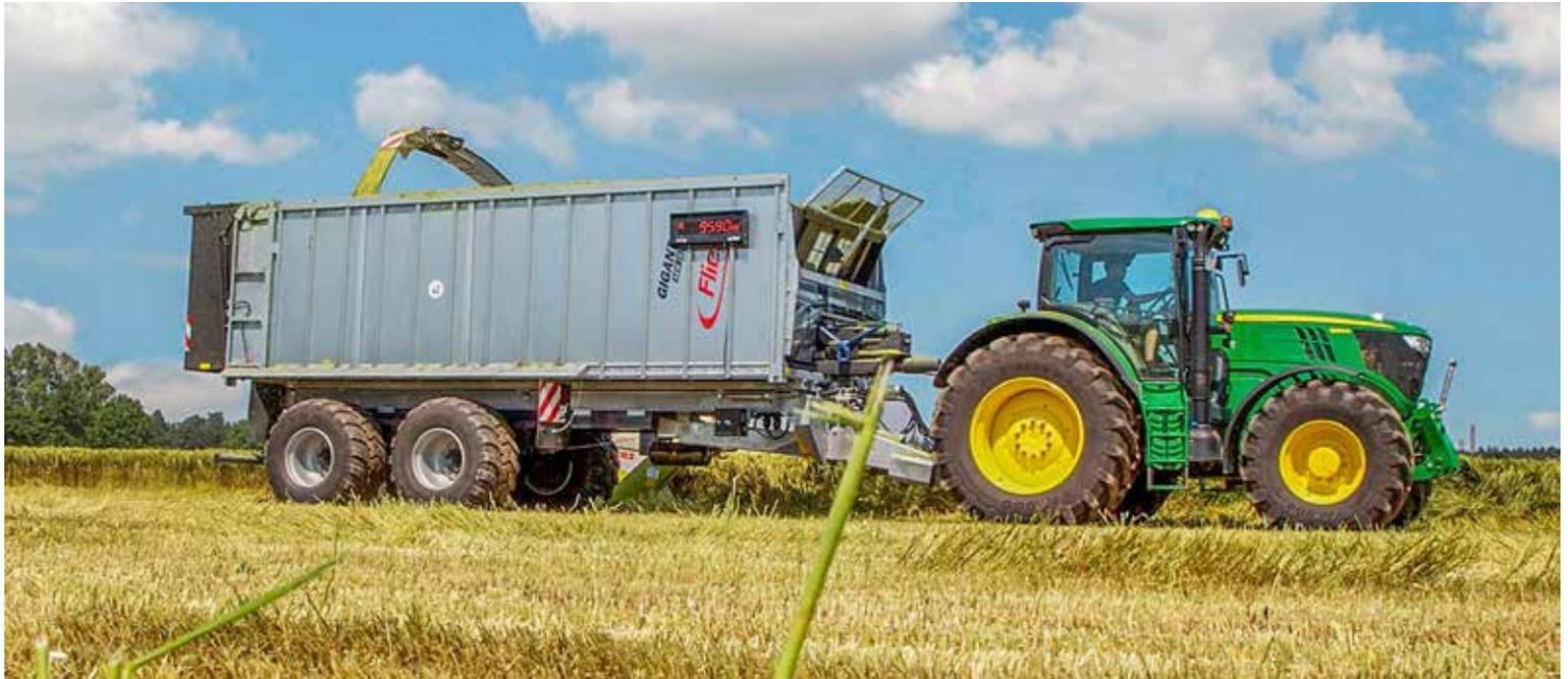
Häckselwagen mit Wiegevorrichtung für eine einfache Kalibrierung der Ertragsfassung am Feldhäcksler
