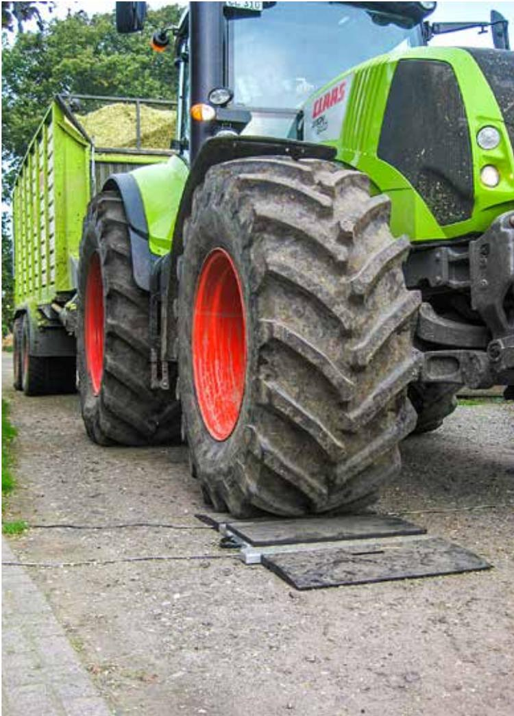
Ertrags erfassung mit mobiler Achslastwaage im überbetrieblichen Einsatz. Die beiden Wiegeplatten werden mit gleichmäßiger Schrittgeschwindigkeit überfahren. Fotos (2): Dr. Jürgen Buchholtz
