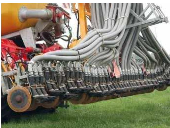
DIE HYDRAULISCH AUFGEHÄNGTEN SCHLITZ-AGGREGATE AM VEENHUIS EUROJECT 3500 PASSEN SICH BODENEUNEHENHEITEN AN.
