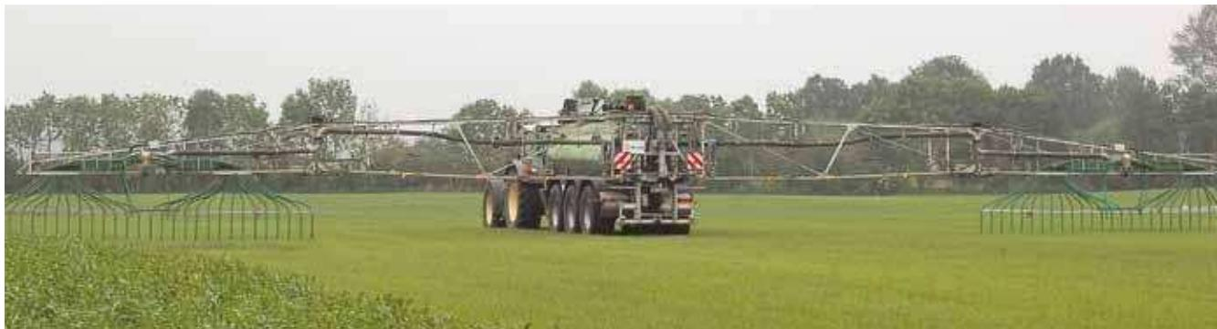
SCHLEPPSCHLAUCHVERTEILER MIT 36 M ARBEITSBREITE AUF GRÜNLAND.
