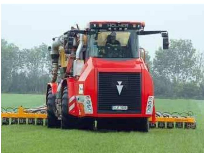
BODENSTRUKTUR UND PFLANZENBESTAND WERDEN DURCH SPURVERSETZTES FAHREN IM „HUNDEGANG“ UND TERRA-BEREIFUNG DES HOLMER-SELBSTFAHRERS GE SCHONT.
